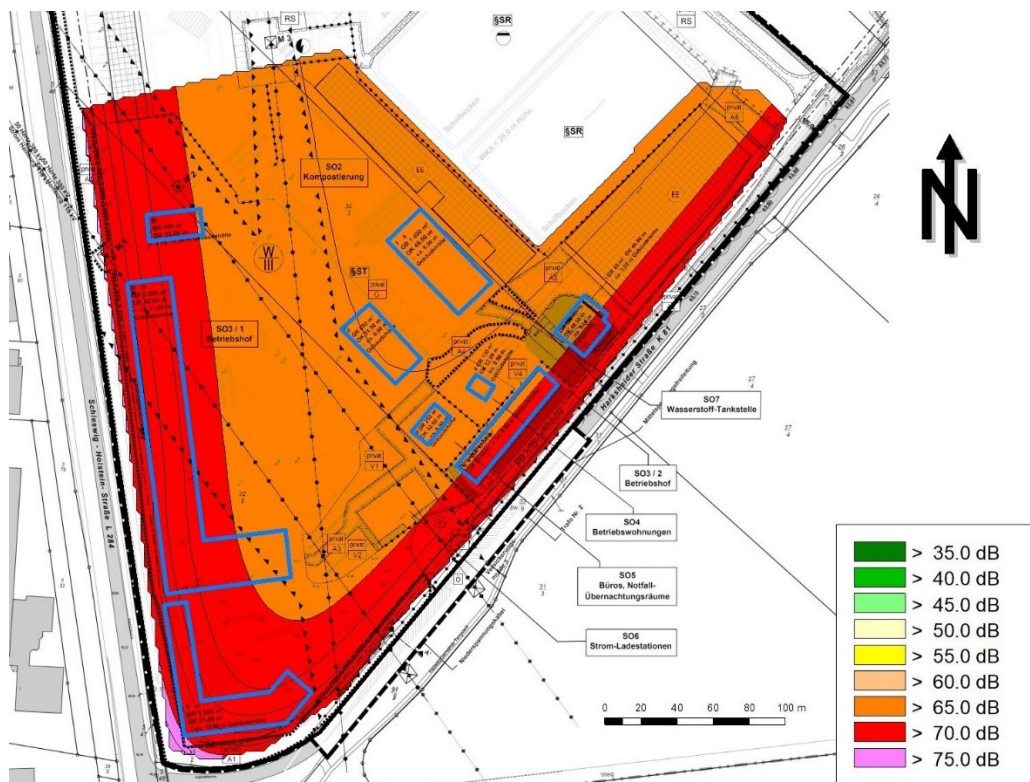
Abbildung 2: maßgeblicher Außenlärmpegel für schutzbedürftige Räume, ohne Maßstab
